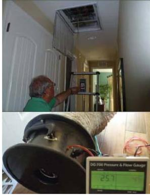
Blower door & leakage test
